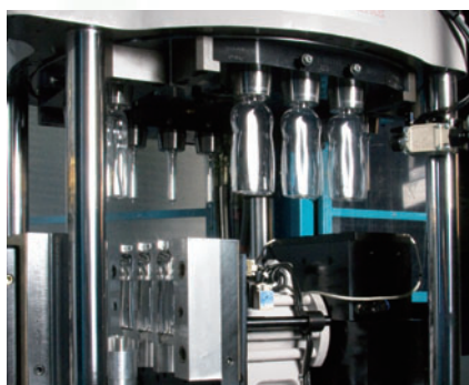
● Molde de soplado y estación de extracción
