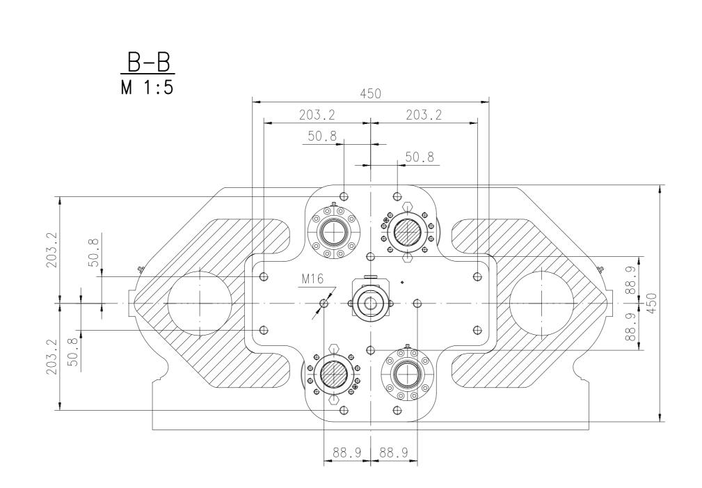
Achtung:Aussermittige Auswerferbohrungen in Aufspannplatte nicht ausgeführt(Option)
